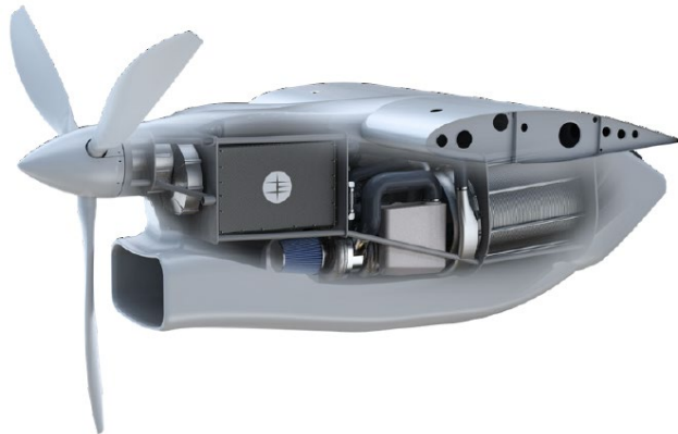
图11-EC 氢燃料电池系统的飞机级集成
